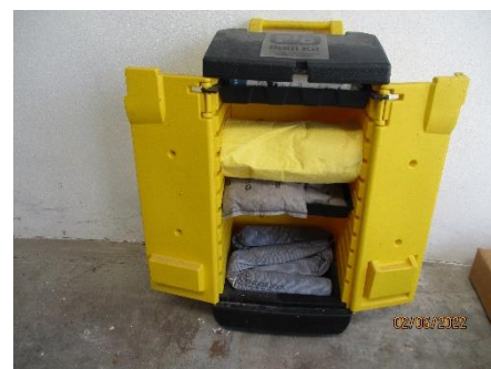
ภาพที่ 2.2-46 อุปกรณ์ควบคุมกรณีสารเคมีหกรั่วไหล
